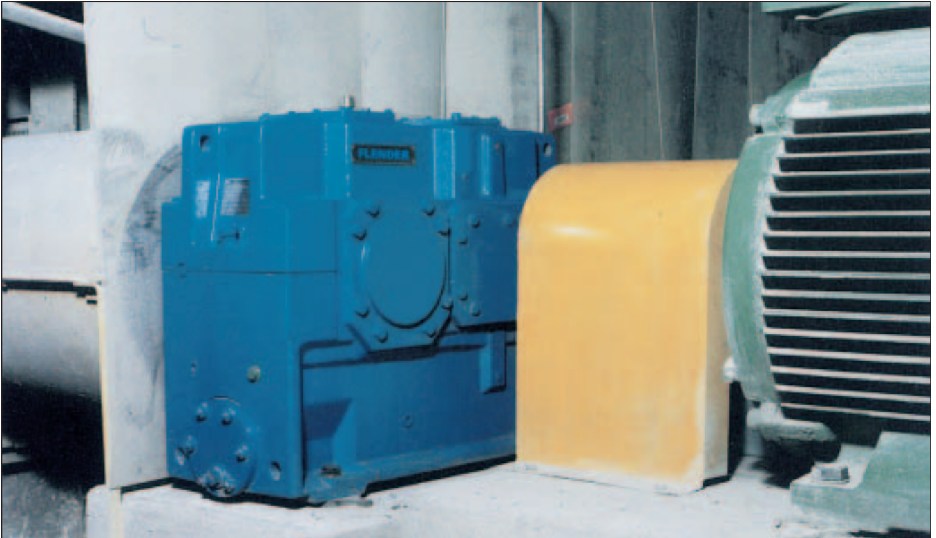
Zweistufiges FLENDER-Stirnradgetriebe der Bauart H2PH 9 im Antrieb einer Saugwalze FLENDER helical gear unit, two-stage, type H2PH 9 driving a suction roll Réducteur à 2 trains d'engrenages cylindriques FLENDER type H2PH 9 pour l'entraînement d'un cylindre aspirant
