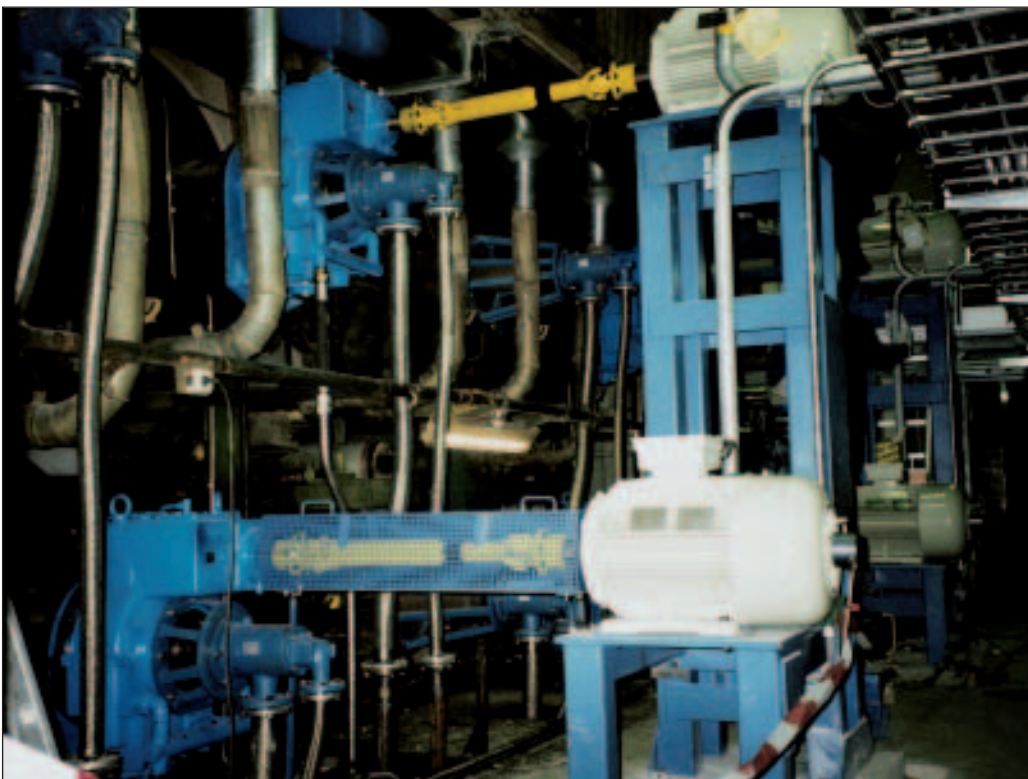
Trockenzylinderantrieb mit FLENDER-Stirnrad-Aufsteckgetriebe der Bauart SHHP 300 und getrenntem elektrischem Antrieb für Ober- und Untersieb, Anlage: KANZAN für v = 800 m/min Drying cylinder drive with shaft-mounted FLENDER helical gear units of type SHHP 300 and separate electrical drive for top and bottom wire; Plant: KANZAN for v = 800 m/min Entraînement du cylindre sècheur avec réducteur cylindrique à arbre creux du type SHHP 300 et avec l'entraînement électrique séparé pour le crible supérieur et le crible inférieur. Installation: KANZAN pour v = 800 m/min
